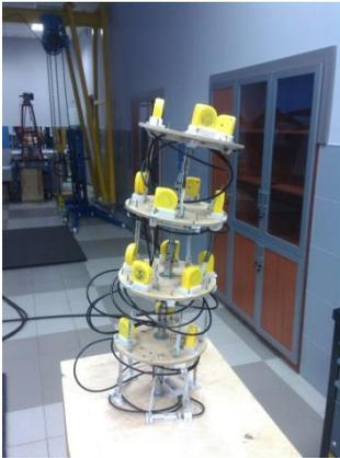
Рисунок 1. Модель гибкого манипулятора
